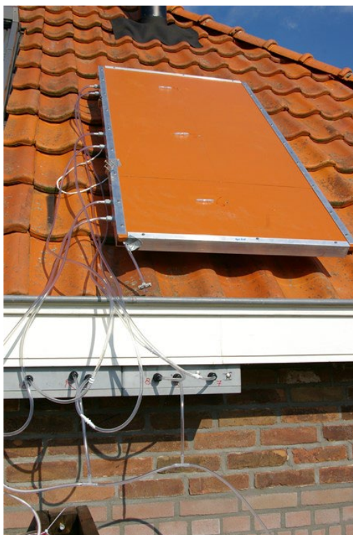
Figuur 8 Foto van opzet voor drukmetingen aan een zonnepaneel.
