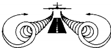
Figuur 1 – weergave van Wake Vortex Turbulentie (bron: CAA UK)
