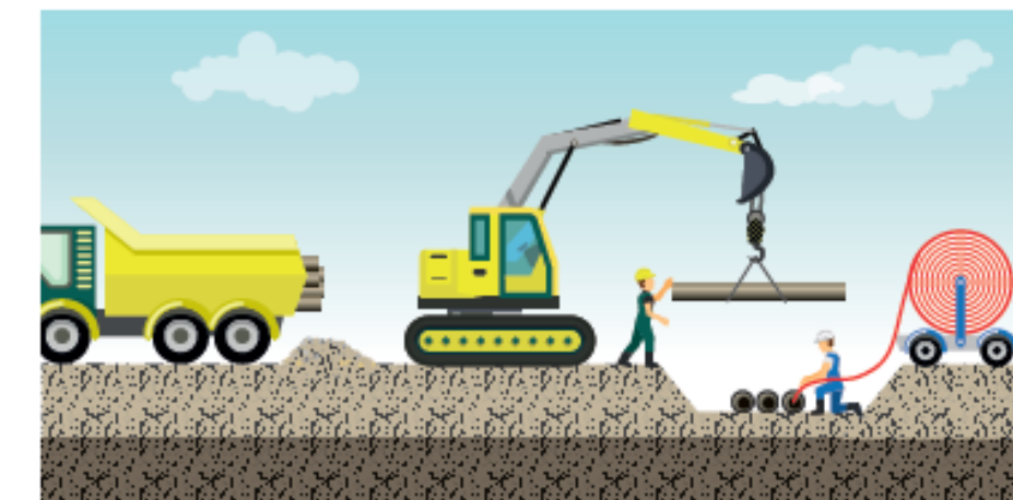
4. AANBRENGEN MANTELBUIZEN IN CUNET I.S.M. SWARCO
